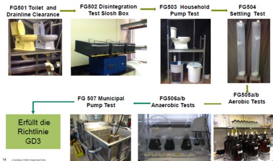
Abbildung 10: Test for „Flushability“ von der Interessenvertretungen EDANA/INDA
